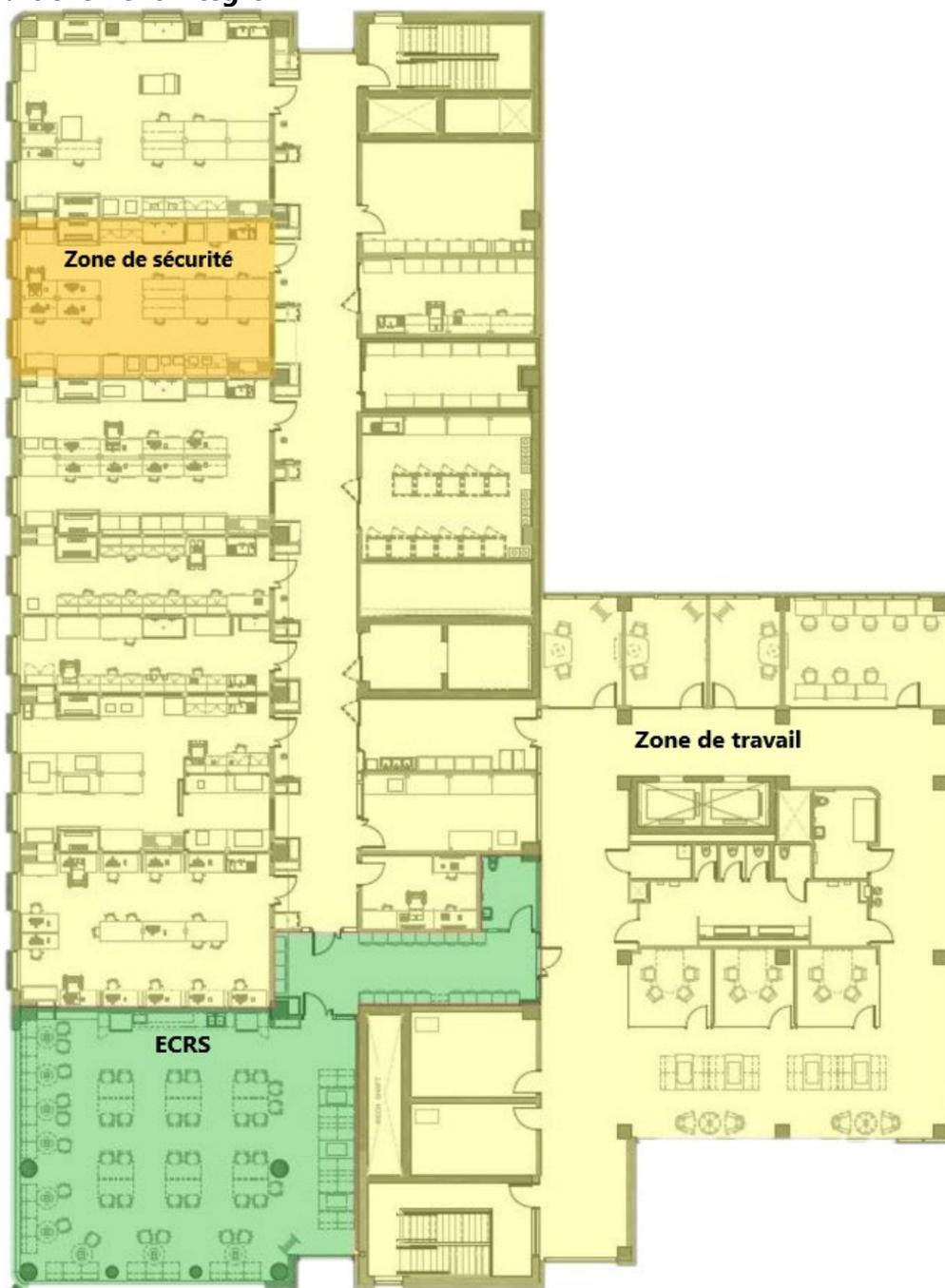
*Texte de remplacement – La figure 2 est un exemple de zone de sécurité matérielle. Ici, l'accès à l'ECRS s'effectue par une zone de travail. Tous les points d'entrée dans les zones sont dotés de points d'accès contrôlés.*
